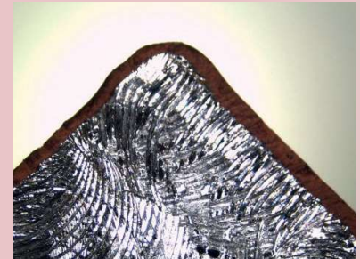
Interseal 1509 retém mais de 70% da espessura original
